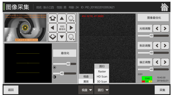
4、选择对位方式，点击【采集界面】（即手动模式） →进入 OCT 图像采集界面
